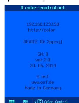
На этой странице отображен IP адрес и NetBIOS имя устройства, которые нужны для доступа к блоку Color-Control.net из локальной компьютерной сети.
